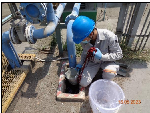
ภาพที่ 3.59 การตรวจวัดคุณภาพน้ำ บริเวณ Regenerate resin ที่ระบายลงสู่บ่อเก็บน้ำทิ้งรวม
