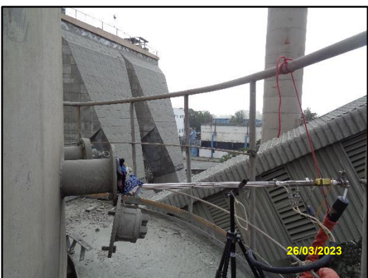
ภาพที่ 3.25 การตรวจวัด TSP จากปล่องหม้อเย็น 1
