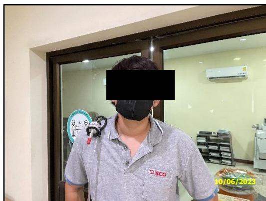
ภาพที่ 3.91 การตรวจวัดฝุ่นที่ติดตัวพนักงานประจำ Packer 6-10
