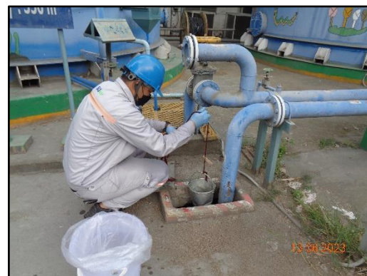
ภาพที่ 3.59 การตรวจวัดคุณภาพน้ำ บริเวณ Regenerate resin ที่ระบายลงสู่บ่อเก็บน้ำทิ้งรวม
