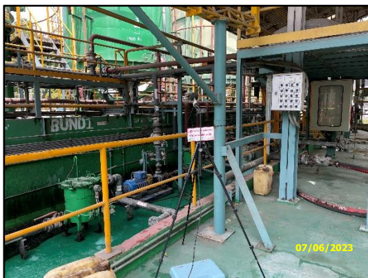
ภาพที่ 3.114 การตรวจวัดระดับเสียงบริเวณเครื่องจักร บริเวณปั๊มสูบน้ำของเสียที่เป็นของเหลว
