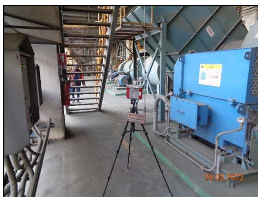
ภาพที่ 3.152 การตรวจวัดความร้อนในสถานที่ ทำงานบริเวณข้างพัดลม 920 B16M
