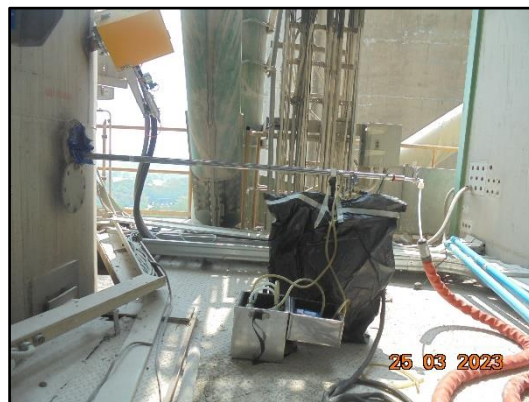
ภาพที่ 3.28 การตรวจวัด TOCจากปล่องหม้อเผา
