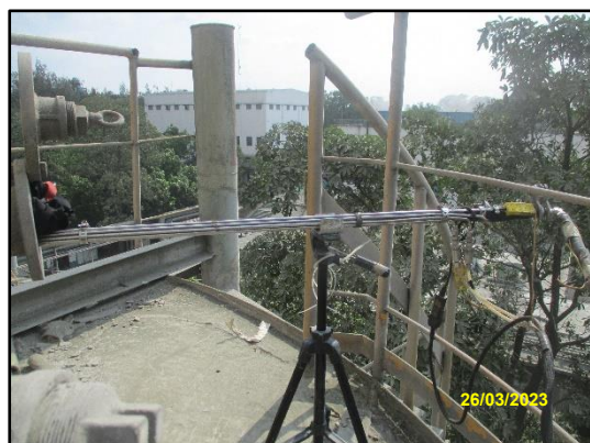
ภาพที่ 3.26 การตรวจวัด TSP จากปล่องหม้อเย็น 2
