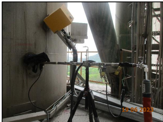
ภาพที่ 3.27 การตรวจวัด HCl และ HF จากปล่องหม้อเผา
