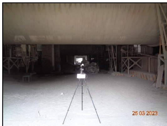
ภาพที่ 3.79 การตรวจวัดฝุ่นในสถานที่ทำงาน บริเวณ Cement Mill 1
