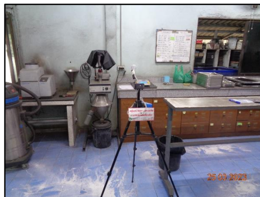
ภาพที่ 3.84 การตรวจวัดฝุ่นในสถานที่ทำงานบริเวณห้องเตรียมตัวอย่าง
