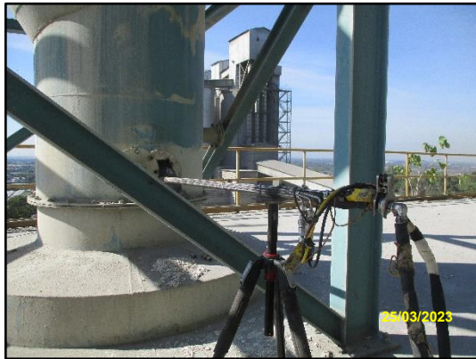
ภาพที่ 3.21 การตรวจวัด TSP จากปล่องหม้ออบซีเมนต์ 3
