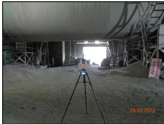
ภาพที่ 3.81 การตรวจวัดฝุ่นในสถานที่ทำงาน บริเวณ Cement Mill 3
