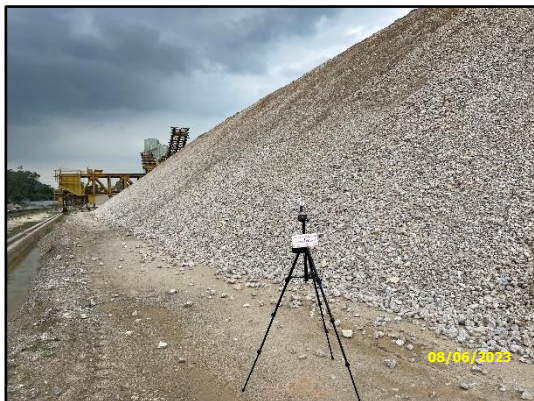
ภาพที่ 3.70 การตรวจวัดฝุ่นในสถานที่ทำงาน บริเวณทิศตะวันออกของกองหิน KW1
