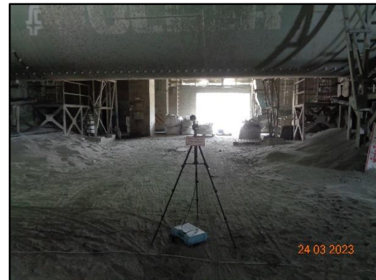
ภาพที่ 3.107 การตรวจวัดระดับเสียงบริเวณ เครื่องจักรบริเวณ Cement Mill 3
