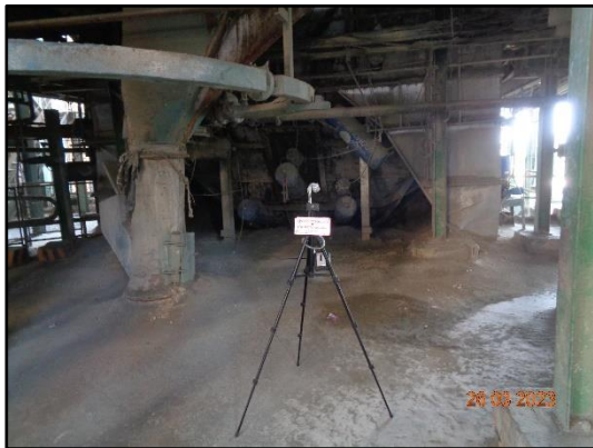
ภาพที่ 3.74 การตรวจวัดฝุ่นในสถานที่ทำงาน บริเวณ Riser pipe ชั้นที่ 1
