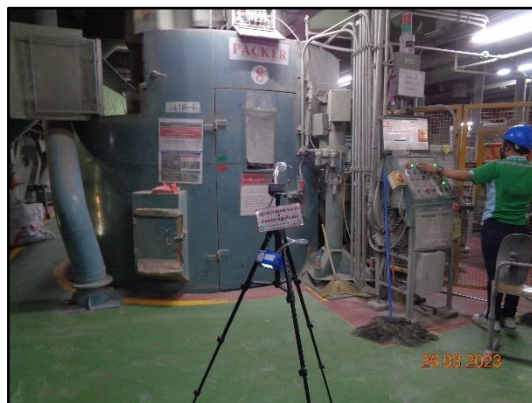
ภาพที่ 3.83 การตรวจวัดฝุ่นในสถานที่ทำงาน บริเวณ Packer 6-10
