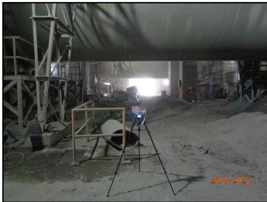
ภาพที่ 3.80 การตรวจวัดฝุ่นในสถานที่ทำงาน บริเวณ Cement Mill 2
