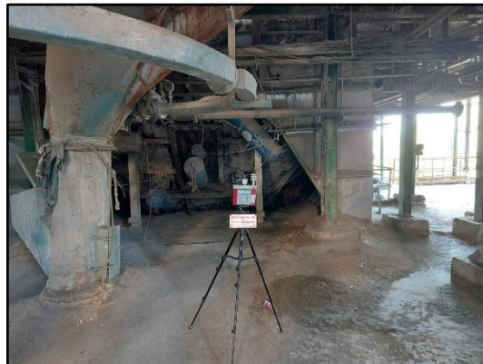
ภาพที่ 3.144 การตรวจวัดความร้อนในสถานที่ทำงานบริเวณ Riser Pipe ชั้น 1
