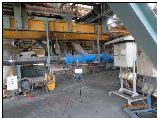
ภาพที่ 3.73 การตรวจวัดฝุ่นในสถานที่ทำงาน บริเวณ Cooler และ Kiln
