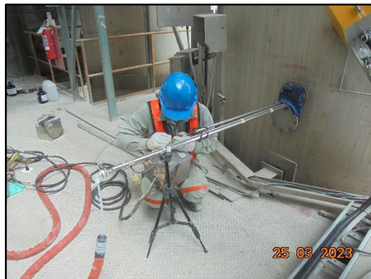
ภาพที่ 3.16 การตรวจวัด NO x as NO 2 จากปล่องหม้อเผา
