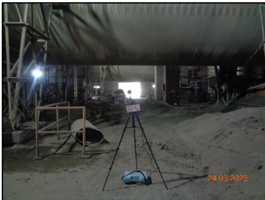
ภาพที่ 3.106 การตรวจวัดระดับเสียงบริเวณ เครื่องจักรบริเวณ Cement Mill 2
