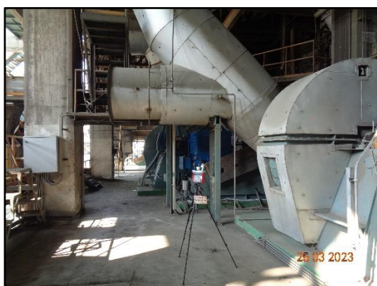
ภาพที่ 3.151 การตรวจวัดความร้อนในสถานที่ ทำงานบริเวณข้างพัดลม 920 B12M
