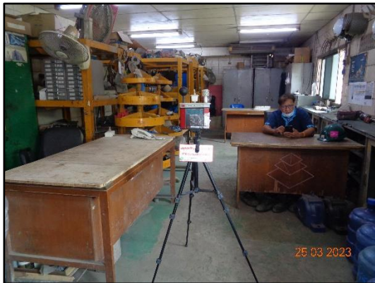
ภาพที่ 3.143 การตรวจวัดความร้อนในสถานที่ทำงานบริเวณห้องทำงานช่าง บริเวณ Cooler
