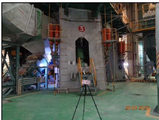
ภาพที่ 3.78 การตรวจวัดฝุ่นในสถานที่ทำงาน บริเวณหม้อบดวัดถุดิบ 2
