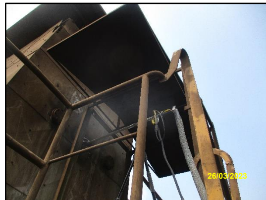
ภาพที่ 3.24 การตรวจวัด TSP จากปล่องหม้ออบคลinker 3
