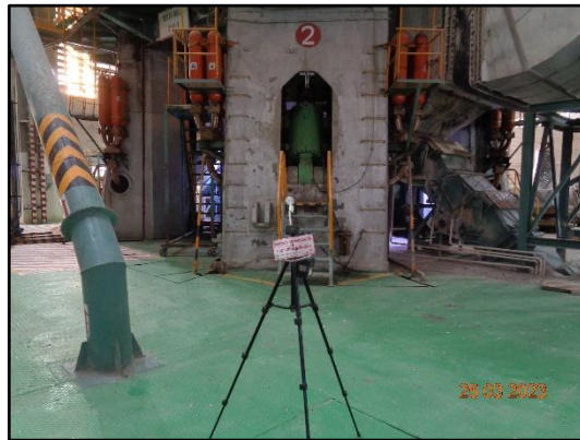
ภาพที่ 3.77 การตรวจวัดฝุ่นในสถานที่ทำงาน บริเวณหม้อบดวัดถุดิบ 1
