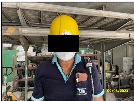
ภาพที่ 3.87 การตรวจวัดฝุ่นที่ติดตัวพนักงาน พนักงานประจำหม้อเผา
