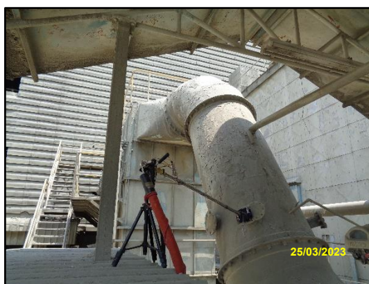
ภาพที่ 3.20 การตรวจวัด TSP จากปล่องหม้อบดซีเมนต์ 2
