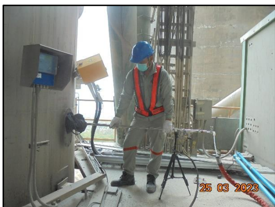
ภาพที่ 3.17 การตรวจวัด SO 2 จากปล่องหม้อเผา
