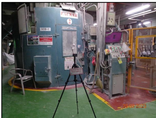
ภาพที่ 3.82 การตรวจวัดฝุ่นในสถานที่ทำงาน บริเวณ Packer 1-5
