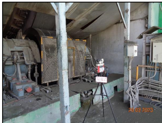
ภาพที่ 3.146 การตรวจวัดความร้อนในสถานที่ทำงานบริเวณลูกกลิ้งแท่น 1
