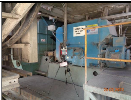
ภาพที่ 3.150 การตรวจวัดความร้อนในสถานที่ ทำงานบริเวณข้างพัดลม 920 B11M
